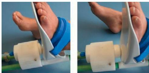
An der Ferse befindet sich eine pneumatische Druckeinheit, durch die das Knie gezielt belastet werden kann, während der Patient im MR-Gerät liegt.
